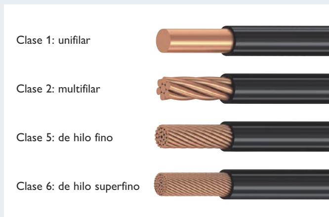
Clases de conductor según IEC/DIN EN 60228 (VDE 0295)
