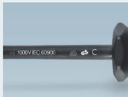
Rotulación de una herramienta VDE. La letra "C" indica la posibilidad de uso a temperaturas bajas
