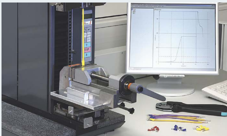
Ensayo de extracción del conductor
